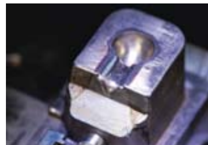
プラスチック金型の入れ子の溶接
