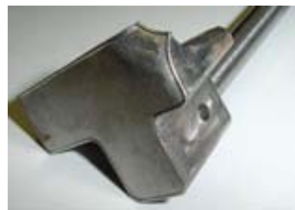
摩耗した防水エッジの修正
